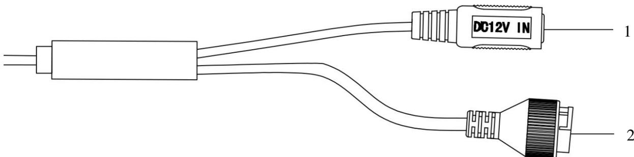
Рис. 1 Разъемы видеокамеры
